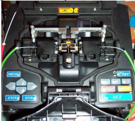
Fig. 3, ubicación de fibras en ambos extremos
