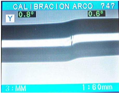
Fig. 5 Calibración por arco
