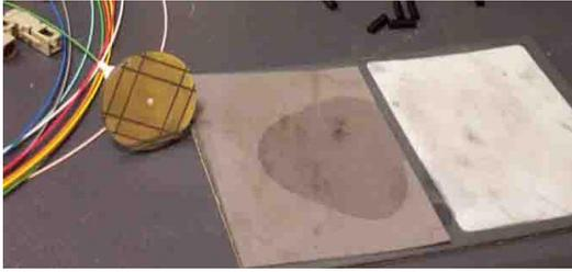
El mismo procedimiento se realiza con lija de 0.3µm y sobre la plancha de cristal.
